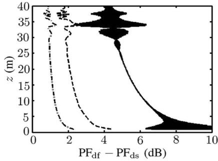
Fig. 8.  $PF_{df}-PF_{ds}$  in case 3. (Dash-dotted line)  $N_{ts} = 10^7$  ( $m^{-3}$ ). (Dash line)  $N_{ts} = 2 \times 10^7$  ( $m^{-3}$ ). (Solid line)  $N_{ts} = 5 \times 10^7$  ( $m^{-3}$ ).
